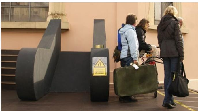
Das Bahnsteigmodell der Ingenieure 22 zeigt im Maßstab 1:1 wie eng es auf dem Bahnsteig von Stuttgart 21 zugehen wird. Zwischen Rolltreppe und Sicherheitsstreifen ist mit 1,24 m gerade mal Platz für zwei Personen.
